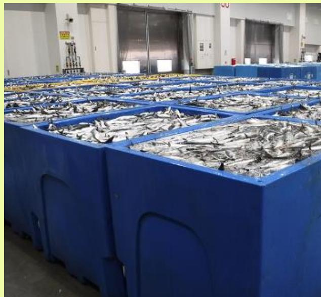
保冷タンクと冷海水による生鮮魚介類の一時保管の例
