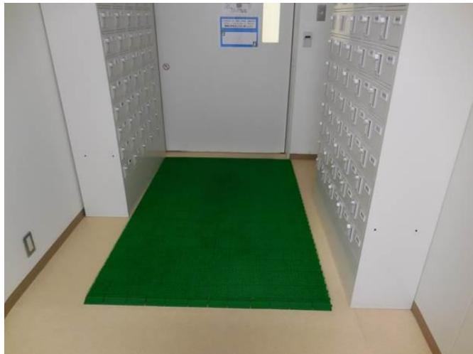
製造室入口に起毛性マット設置：毛髪対策
