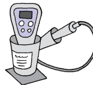
壊れないように収納容器を作り、サーミスタ温度計がすぐ取り出せるようにしている。校正記録の表示ラベルがついている
