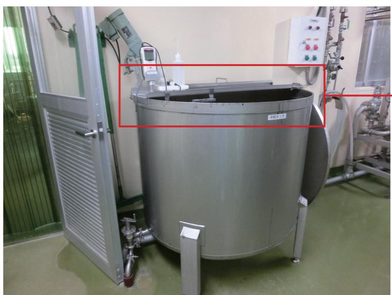
攪拌機の取り付けられている蓋部分の内側には汚れが付着・堆積する可能性があることから、定期的な点検・洗浄を行います。
