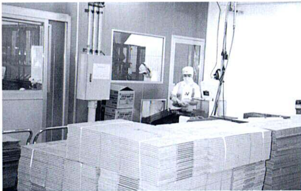
包装室と外箱詰め室との区画
